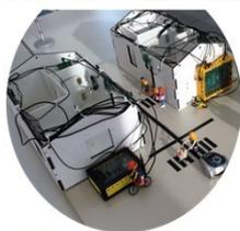
Les **câbles** permettent de transmettre le signal des capteurs à l'interface programmable (ici, des boîtiers Picaxes).
