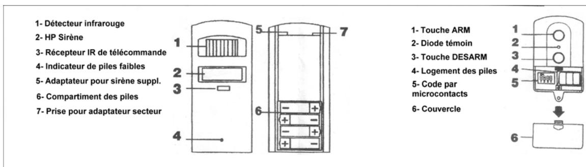
L'alarme est livrée avec les piles insérées. Pour la mise sous tension, ouvrir le couvercle de piles en démontant la vis située à la base du détecteur.
